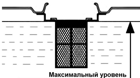
Рис. 8 Максимальный уровень топлива в топливном баке
