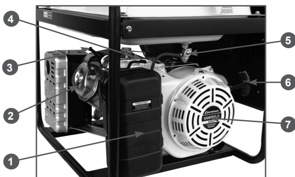
Рис. 2 Основные узлы и органы управления (двигатель)
