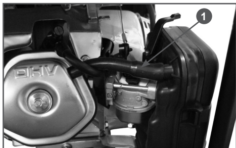
Рис. 12 Трубка системы вентиляции картера
